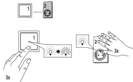
Ohjelmoi seuraavaksi loput vastaanottimet **yksitellen** painikkeella käyttämällä järjestelmänvalvontaa:
