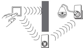
Den apparatspecifika adresseringen av radiokommandona gör det möjligt för flera radiosystem att fungera sida vid sida. Den omfattande funktionsbredden gör att radiosystemet CONNECT är stabilt, störningssäkert och flexibelt.
